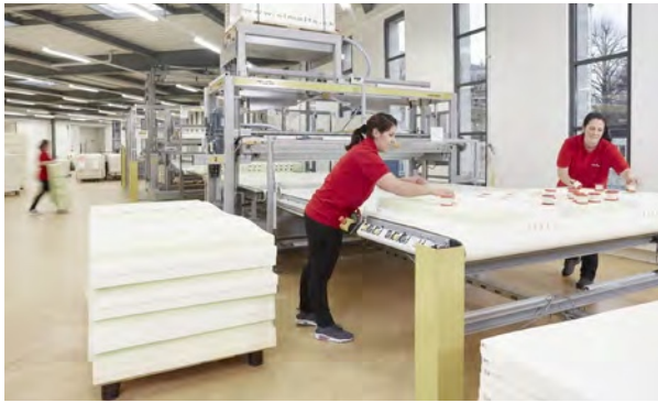
Matratzenkernkonfektion, bei welcher die geschnittenen und profilierten Schaumstoffe und Latexschäume miteinander verklebt werden.
