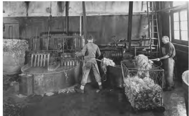
In der Wäscherei werden die Rosshaare im Levian mit Seife warm gewaschen.
