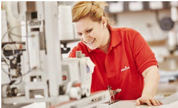
Der Reissverschluss wird in die Matratzenhülle eingenäht.
